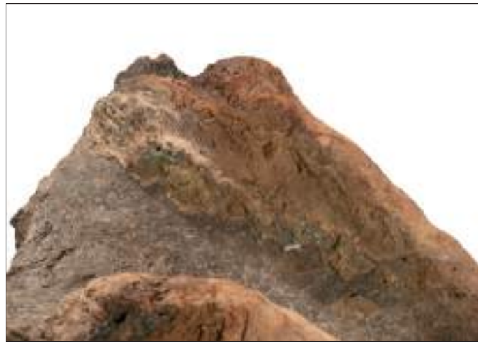
Fig. 9. Détail des résidus d'alliage cuivreux sur la paroi interne du creuset © CNRS-CFEETK/Ph. Soubias.
